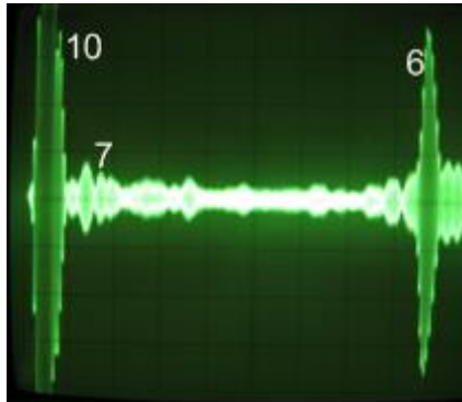
Рис. 2. Развертка на экране осциллографа при отсутствии дефектов на поверхности листа из стали ст.3 толщиной 30 мм длиной 1000мм.
